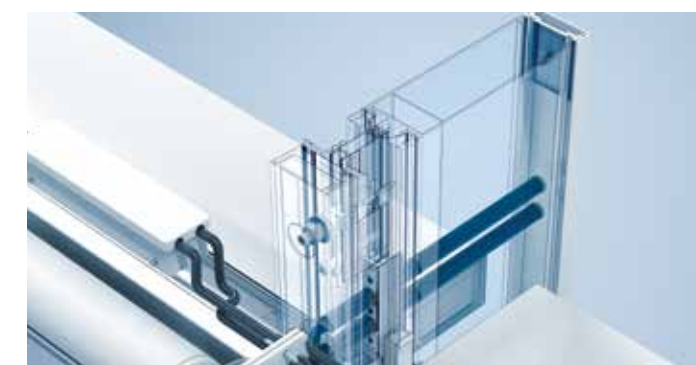
Kabeldoorvoer tussen integratieprofiel en stijl
