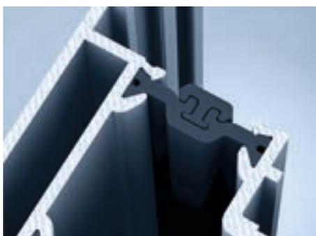
**Étape 1 :** Pour prévenir les effets considérables des écarts de température sur le fonctionnement et l'apparence des éléments coulissants à levage, heroal a mis au point un profilé composé anti-distorsion breveté. Il protège le profilé des forces de cisaillement néfastes. Ce composé est constitué d'une traverse d'isolation enroulée et d'un ressort d'insertion.
